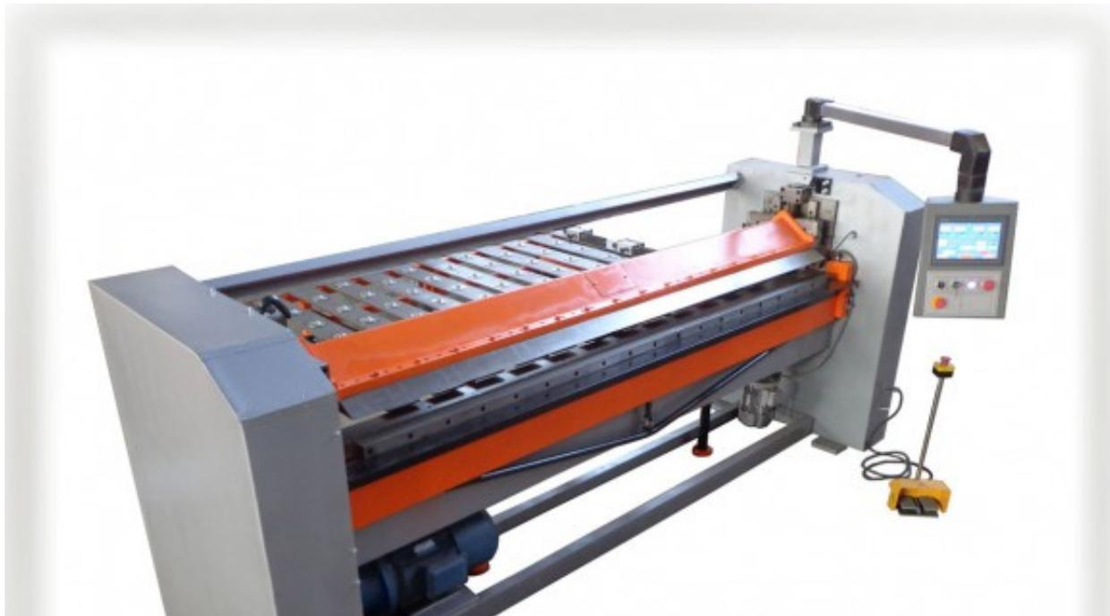
Электромеханический гибочный станок ЧПУ с поворотной балкой работает с холоднокатаными листовыми металлами, оцинкованной сталью с полимерным покрытием, медными и алюминиевыми листами толщиной металла до 1.5 мм
