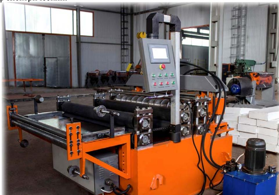
На линии установлен: цепной привод, четкий и надежный контроль скоростей, длины и местоположения.
